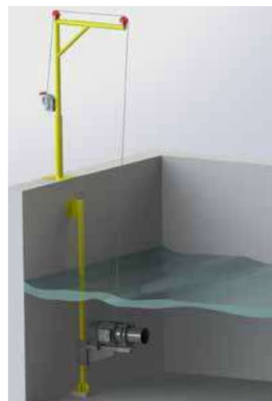
HM com sistema de içamento
