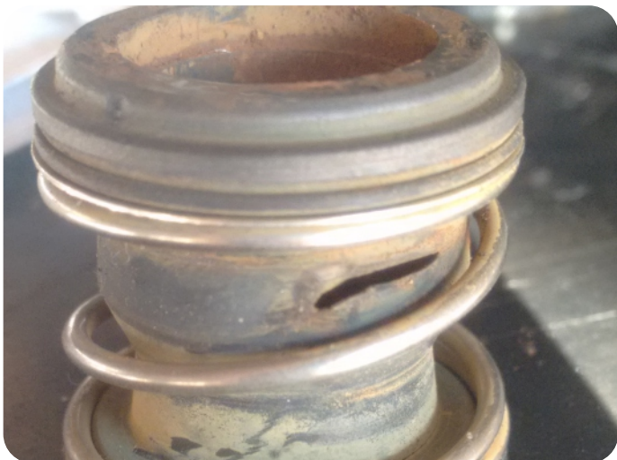
Figura 13.9 – Estresse da borracha devido ao elevado número de partidas
