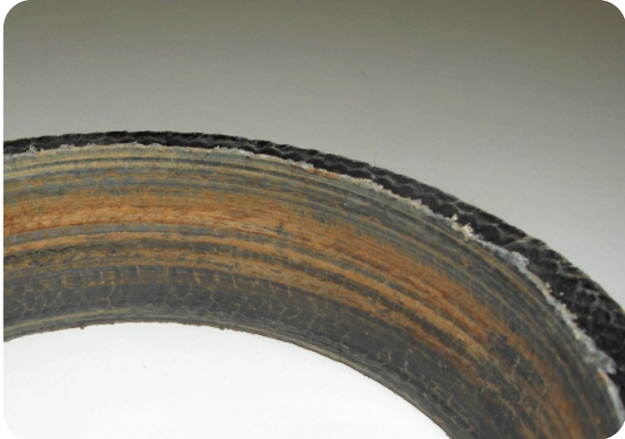
Figura 13.6 – Face danificada devido a sólidos
