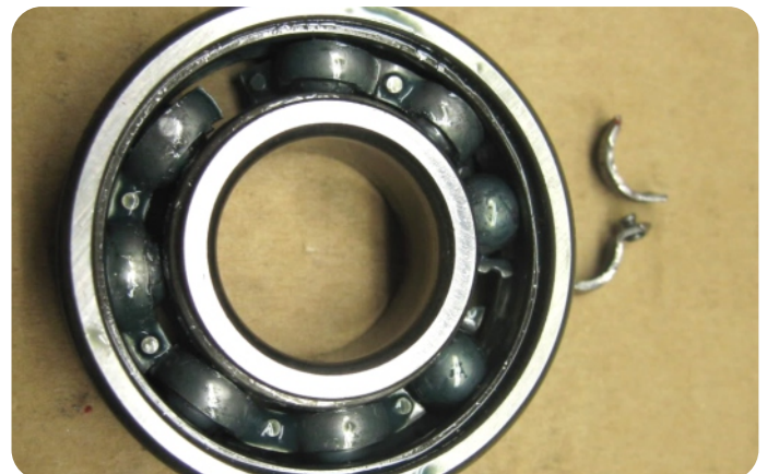
Figura 2.9 – Rolamento quebrado por vibração
