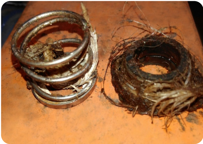
Figura 13.8 – Líquido bombeado inadequado para o selo mecânico
