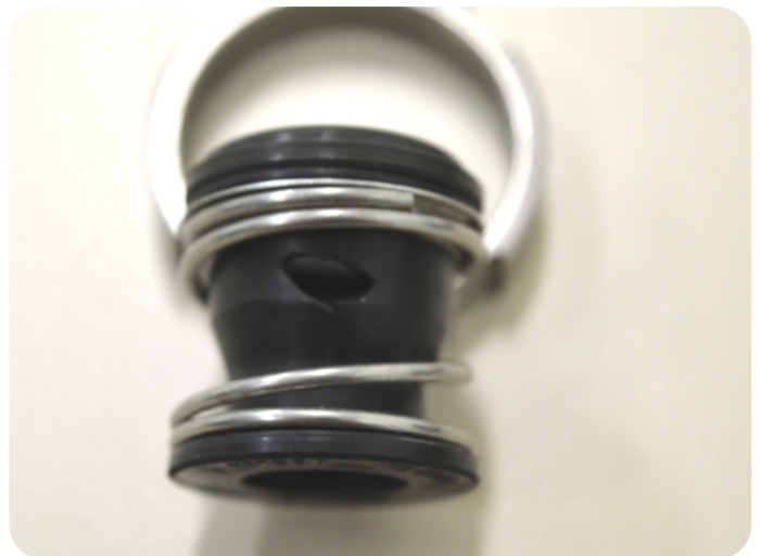
Figura 13.9 – Estresse da borracha devido ao elevado número de partidas
