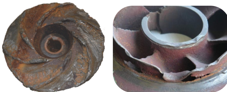
Figura 3.3 - Efeitos da cavitação
