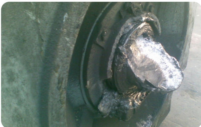
Figura 2.8 – Eixo do motor quebrado por vibração
