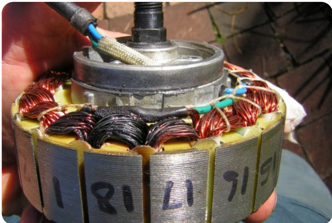
Figura 13.14 – Motor queimado por superaquecimento
