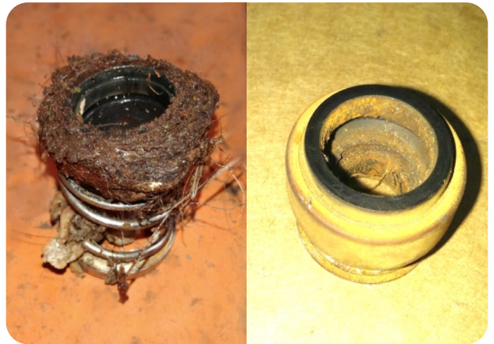
Figura 13.8 – Líquido bombeado inadequado para o selo mecânico
