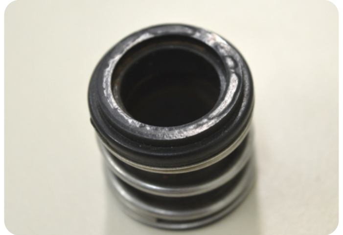
Figura 13.7 – Face danificada por produto químico
